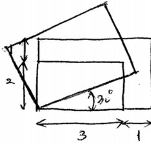
$${}^t_0\mathbf{X} = \begin{bmatrix} \frac{\sqrt{3}}{2} & -\frac{1}{2} \\ \frac{1}{2} & \frac{\sqrt{3}}{2} \end{bmatrix} \begin{bmatrix} \frac{4}{3} & 0 \\ 0 & \frac{3}{2} \end{bmatrix} \quad (11.30)$$
